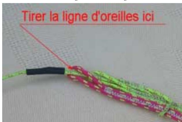
*Photo 92 Sortie de la suspente d'oreille des suspentes A extérieures*
