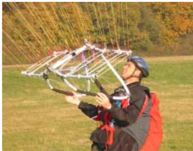
*Photo 56 Contrôle de la voile, mains tenant les lyres par le dessous*
