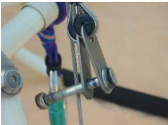
*Photo 72* Vis et écrou tenant les deux plaquettes de câbles
