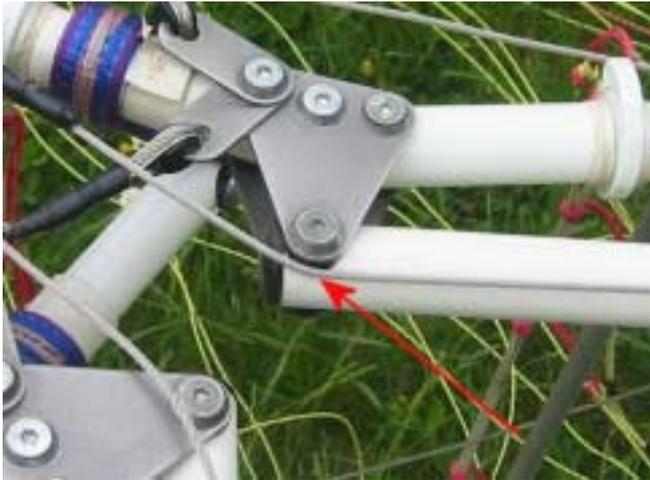
*Photo 30 Câble pris dans une plaquette au repliage*
