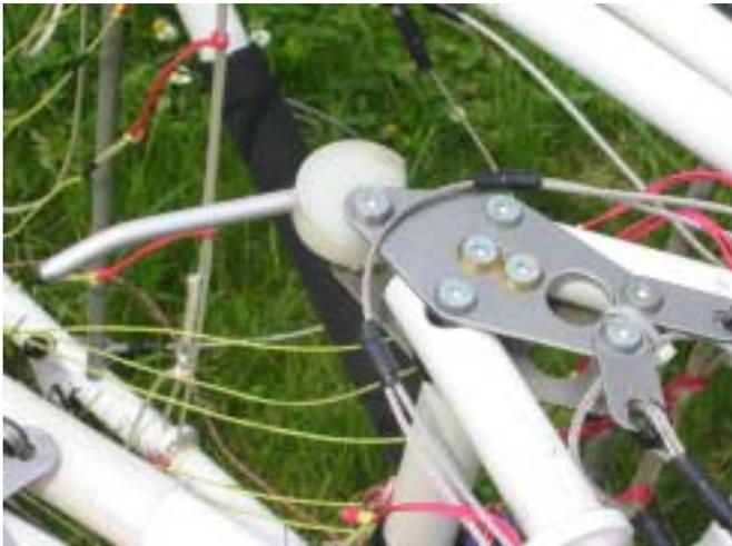
*Photo 16 Détail position des cames pour ne pas gêner l'ouverture*
