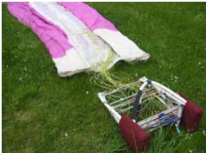
*Photo 8 Voile au sol avec centre déplié pour dégager les suspentes*
