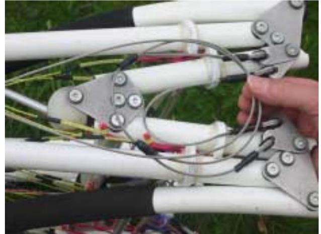
*Photo 32 Détail lovage des câbles dans les protections*
