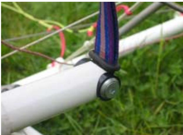
Photo 65 Barreau de Titi et sangles : Points d'usure
