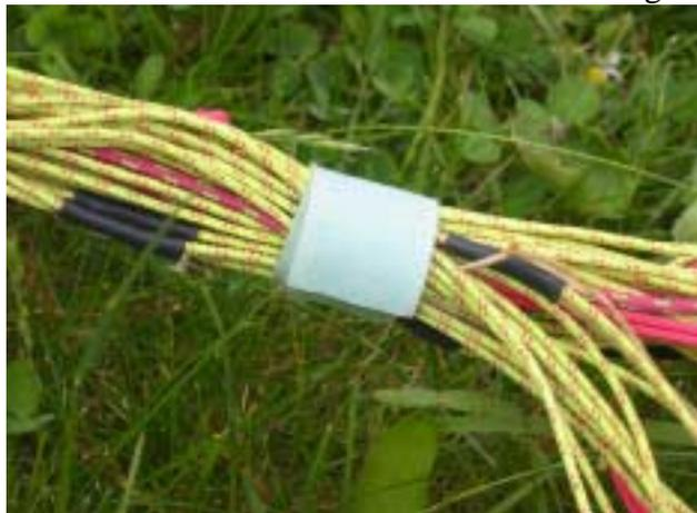
*Photo 34 Bride Velcro pour attacher les suspentes*
