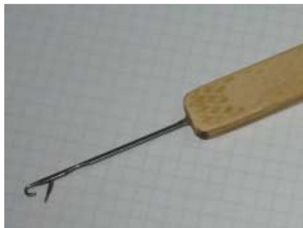
*Photo 77 Outil d'aiguilletage des estropes*
