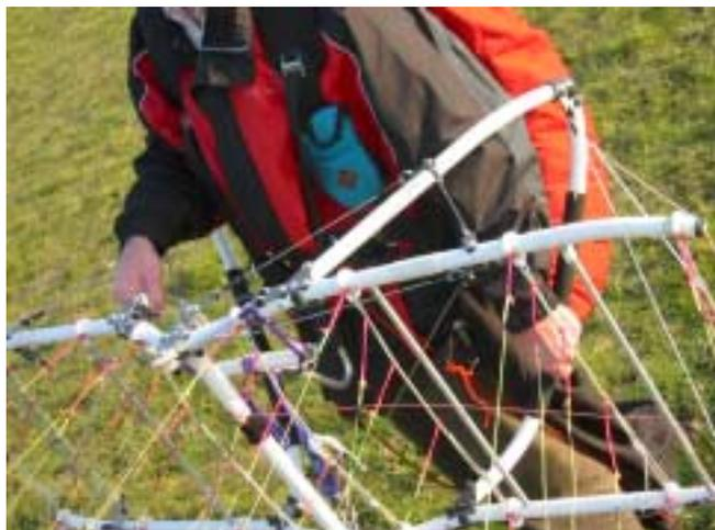
Photo 46 Position des mains sur la cage pour prégonflage (une devant, une derrière)
