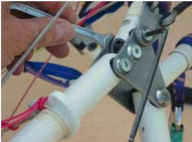
*Photo 71* Détail vis fusible
