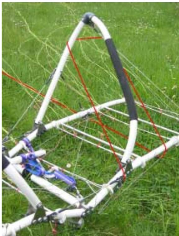
*Photo 22 Position sécurité avec arrières centrales passées dans les lyres*
