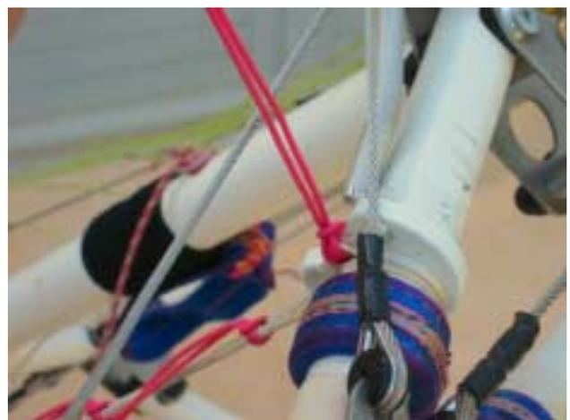
*Photo 76 Passage des estropes A, par rapport au câble avant*
